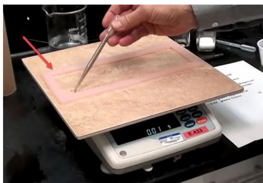
图 A.8 - 瓷砖上 B 类污渍应用模板的位置
