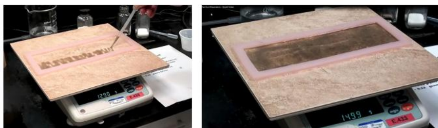
图 A.9 - 用移液管污染一块瓷砖
