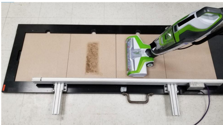
图 A.11 - 瓷砖放置和清理行程的起始位置
